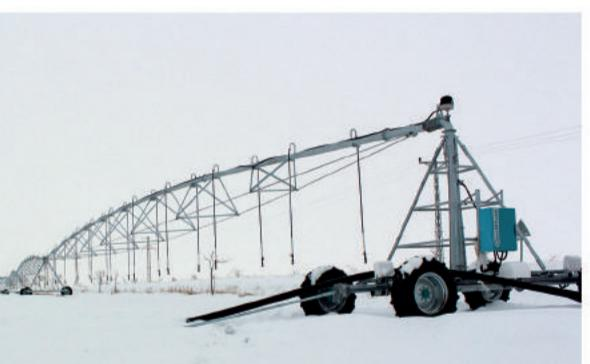
Универсальные дождевые системы были разработаны путем объединения принципов работы круговых и фронтальных машин, для полей неправильной формы и размеров, с целью повышения их урожайности. Это единственная система, которая имеет функцию автоматического переключения между режимами кругового и фронтального полива.
